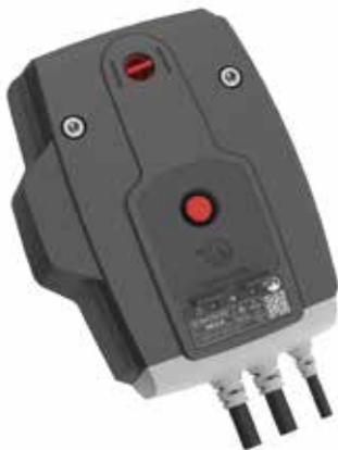
Le ONE-X est un composant unique du système ZENiX : un servomoteur à ressort de rappel avec un module de communication ZENiX intégré. Il est préassemblé sur le clapet coupe-feu, ne nécessite aucun adressage ou configuration et est immédiatement prêt à être connecté. Le ONE-X permet de gagner du temps lors de l'installation, de réduire les erreurs de câblage et d'économiser de l'espace.
