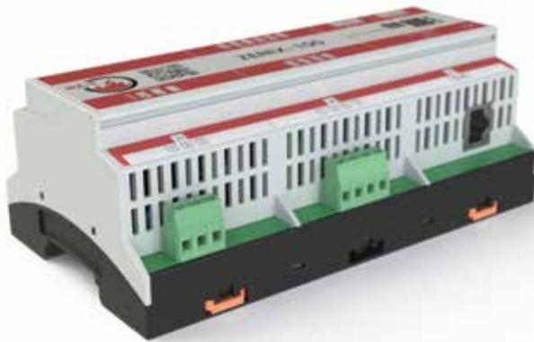
Le système ZENiX est un système complet de contrôle des clapets coupe-feu, des clapets de désenfumage et des volets, des entrées et des sorties. Il surveille en permanence l'état de tous les composants du réseau de bus et procède aux ajustements nécessaires.
